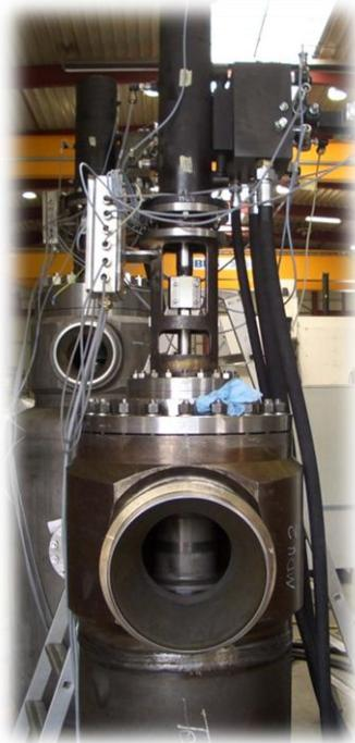
При работе одного насоса, в следствии постоянного регулирования потока, максимальный поток рабочей среды, для загрузки гидроаккумулятора и для нормального режима работы, доступен через вентили пропорционального регулирования.
