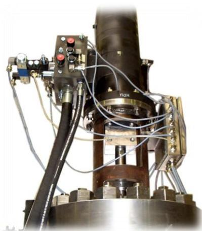
Гидравлический агрегат управляет гидравлическим поршневым приводом арматуры высокого, среднего и низких давлений, например РОУ, БРОУ. А также гидравлическим поршневым приводом, например впрыскивающего клапана.
